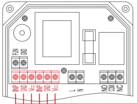
Клеммы для подключения датчиков протечки воды:
