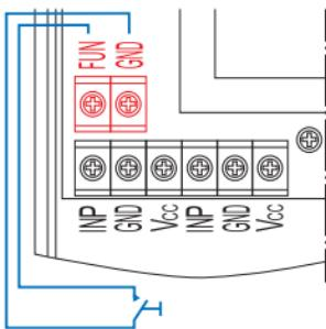
Для ручного перекрытия водоснабжения Вам достаточно подключить клеммы FUN, GND блока управления к стандартному выключателю. Выключатель может находиться в удобном для Вас месте (например, в коридоре). Теперь, уходя из квартиры, для отключения водоснабжения достаточно будет нажать на выключатель.
