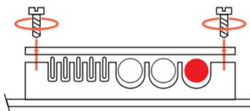
Место ввода кабеля управления электрическим насосом.
