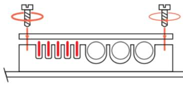
Место ввода кабелей датчиков протечки воды.
