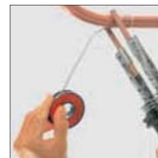
Нагрев места пайки без использования пламени
