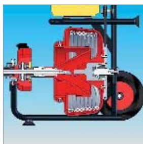
Защита спирали благодаря принудительному направлению в барабане
