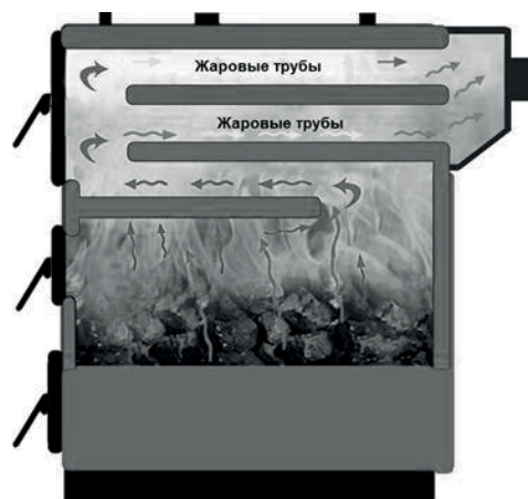
Рис. 3. Котел VULKAN SR 20-100, схема движения дымовых газов.
