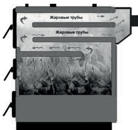
Рис. 5. Котел VULKAN SR 20-100, схема движения дымовых газов.
