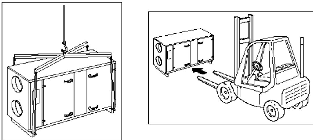
Агрегат поставляется в рабочем горизонтальном положении на 2 транспортировочных поперечных балках, для возможности подъема и перемещения агрегата с помощью автопогрузчика, паллетного грузопогрузчика или крана. При подъеме краном соблюдайте правильную балансировку агрегата. Перед окончательной установкой на месте снимите поперечные балки и приделайте к раме агрегата регулируемые опорные стойки.
