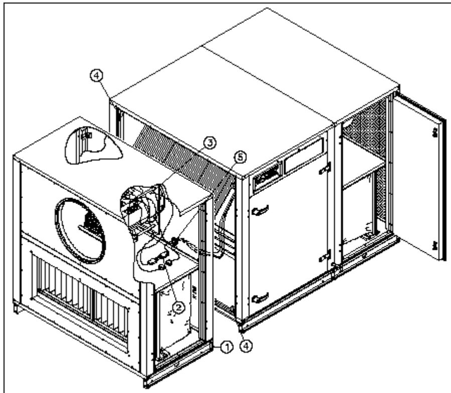
Для сборки агрегата повторите вышеперечисленные действия в обратном порядке.
