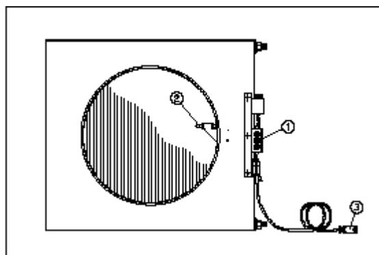
После этого установите калорифер на агрегате Vent и подсоедините разъем сигнального кабеля (3) к панели управления агрегата Vent (см. раздел 5).
