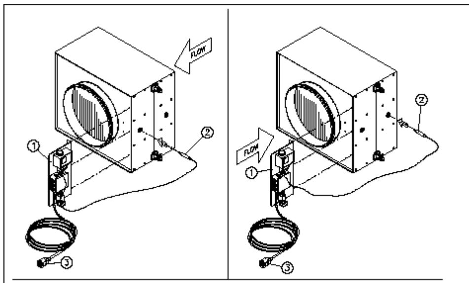
Для сохранности при транспортировке контактная коробка и термореле защиты от замерзания (1) на заводе-изготовителе не монтируются. Сначала прикрепите реле к водяному калориферу с помощью прилагаемых винтов. Далее установите капиллярный датчик термореле (2) с помощью прилагаемого фитинга так, чтобы датчик располагался за калорифером по ходу движения воздушного потока.
