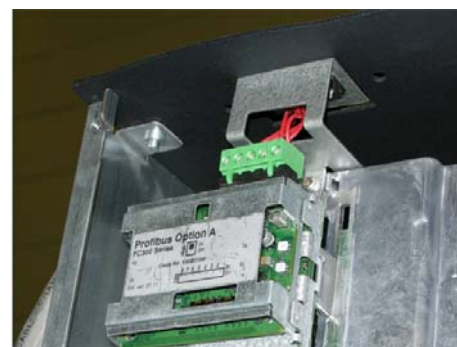
Рисунок 3.53: Подключение шины сети fieldbus сверху.
