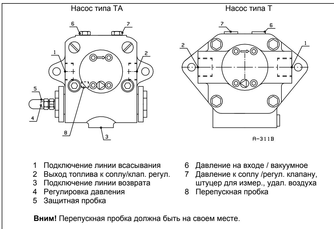
Давление топлива на входе в насос: 1 - 5 бар
