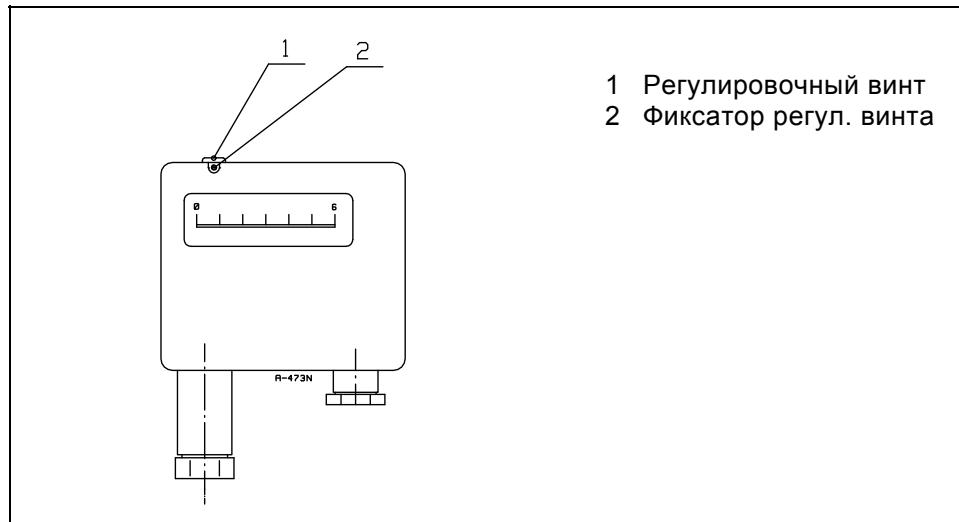
Реле давления топлива (макс.) контролирует давление топлива в возвратной трубе. Если давление превышает заданное значение ( заводская уставка 6 бар), горелка останавливается.
