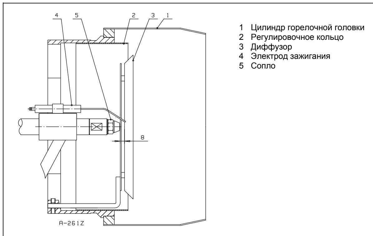
Размер 8 мм в рисунке означает расстояние сопла от задней поверхности диффузора.
