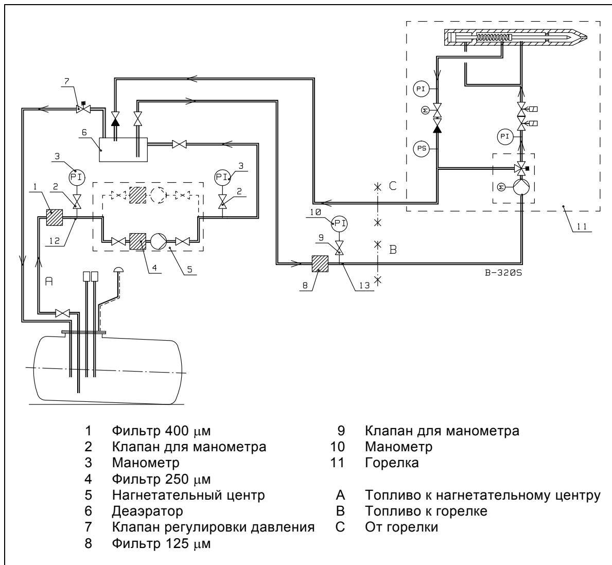
Производительность насосной станции должна быть на 200 кг/ч выше сжигаемого количества топлива. Например, при производительности горелки 600 кг/ч  $\Rightarrow$  требуемая производительность насосной станции ок. 800 кг/ч.
