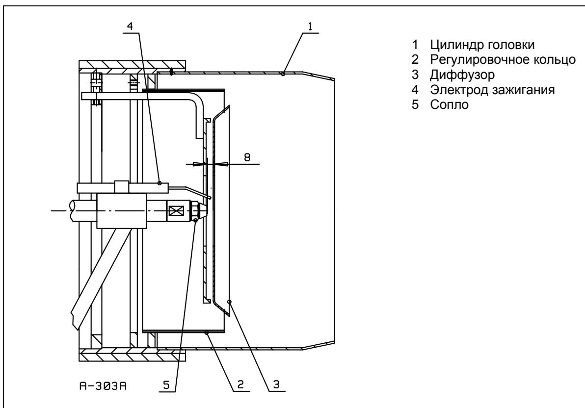
Размер 8 мм в рисунке означает расстояние сопла от задней поверхности диффузора.
