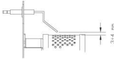
**SCHEMA REGOLAZIONE TERMOCOPPIA - SCHEMA DE REGLAGE DU THERMOCOUPLE - SCHEMA FÜR DIE EINSTELLUNG DES THERMOELEMENTS - THERMOCOUPLE SETTING DIAGRAM - ESQUEMA DE REGULACIÓN DEL TERMOPAR - СХЕМА РЕГУЛИРОВКИ ТЕРМОПАРЫ - AFSTELSCHEMA THERMOKOPPEL - SCHEMAT REGULACJI TERMOPARY**
