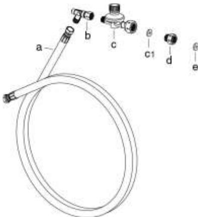
В зависимости от страны назначения теплогенератор поставляется с одним из трех различных регуляторов давления газа.
