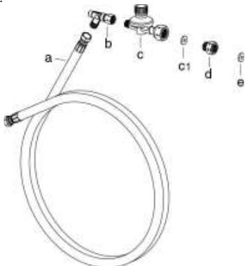
W zależności od kraju, do jakiego jest przeznaczona, nagrzewnica powietrza może być wyposażona w różnego typu regulatory ciśnienia gazu:
