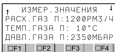
Изобр. 15: Измеряемые значения расхода газа (эксплуатац.-м 3 /ч), температуры и давления газа, горелка справа
