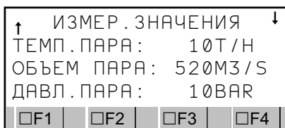
Изобр. 16: Измеряемые значения расхода пара, объёма и давления пара
