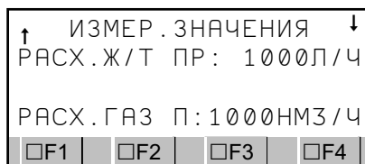
Изобр. 14: Измеряемые значения расхода жидкого топлива и газа (норм-м 3 /ч), горелка справа
