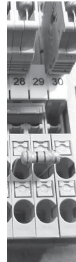
Նկար 7 Դիմադրության (ռեզիստորի) տեղադրման օրինակ
