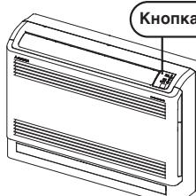
Кнопка ВКЛ/ВЫКЛ на приборе
