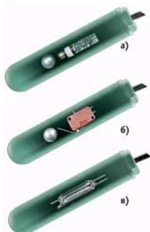
Рис. 4. Устройство поплавковых выключателей
