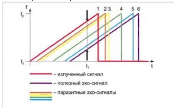
Рис. 26. Паразитные отражения при использовании технологии FMCW
