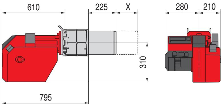
X = удлинение горелочной трубы 100 мм и 200 мм
