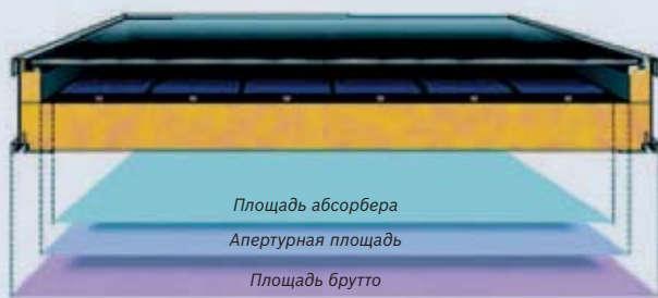
Рис. 147. Виды поверхности плоского солнечного коллектора
