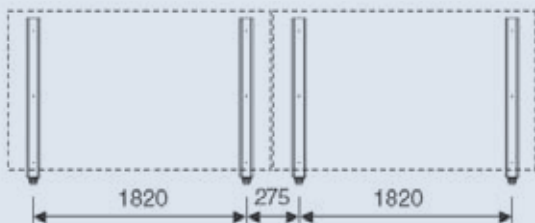
Рис. 247. Типовое исполнение для 2-х горизонтальных солнечных коллекторов
