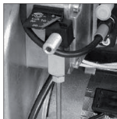
Рис. 16: Регулировка подпорной шайбы горелки
