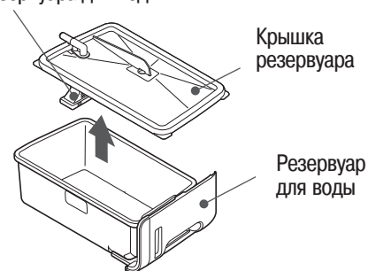
Фильтр резервуара для воды
