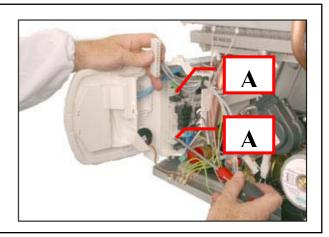
2. Отсоединить разъемы электрических проводов. Отсоединить провод заземления (Рис.1) и провод электрода ионизации (Рис. 2);
