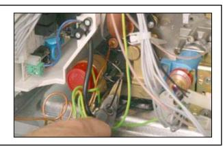
**2.** Демонтировать предохранительный клапан.
