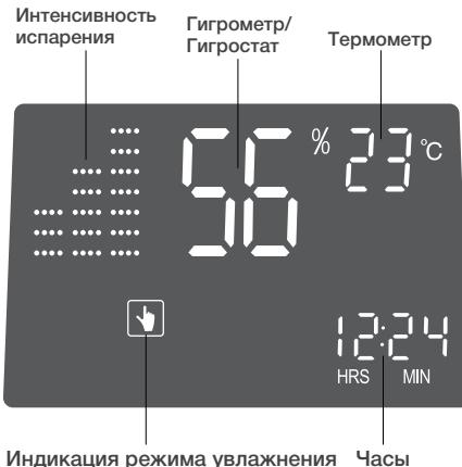
Рис. 4b Стандартный дисплей для режимов увлажнения
