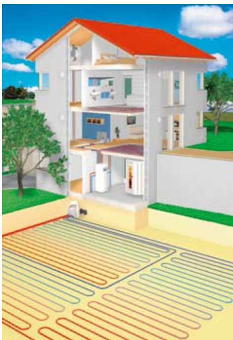
Монтаж коллектора теплового насоса типа «грунт – вода» (горизонтальный коллектор)
