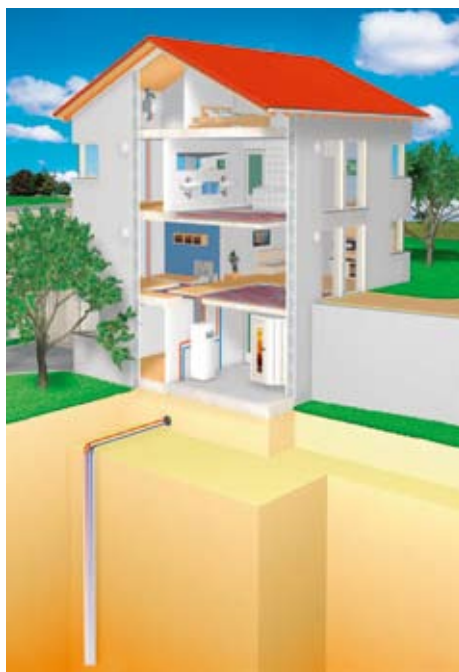
Монтаж коллектора теплового насоса типа «грунт – вода» (вертикальный коллектор)
