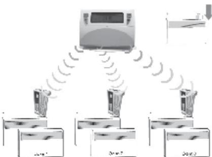
Программатор посылает запрограммированную информацию приемнику посредством радиоволн.
