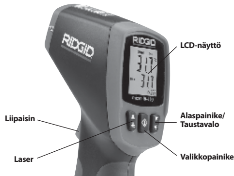
Kuva 8 – micro IR-100: N näyttö/painikkeet
