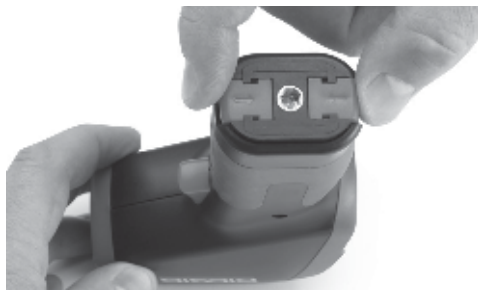
Slika 4 – Uklanjanje poklopca odjeljka za baterije
