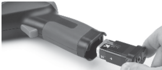
Slika 5 – Nosač baterije i oznaka polariteta
