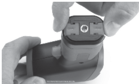
Figuur 4 – Verwijderen van batterijhouder
