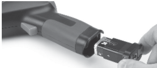
Figura 5 – Portapila y marcas de polaridad
