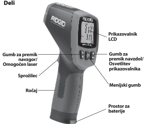
Slika 2 – Deli instrumenta micro IR-100
