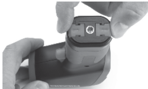
Рис. 4 – Извлечение держателя батарейки
