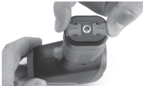
Slika 4 – Skidanje odeljka za baterije
