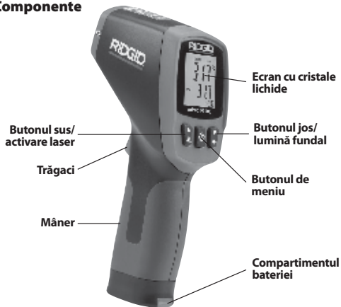
Figura 2 – Componentele micro IR-100
