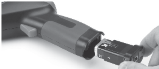
Obrázek 5 – Schránka baterie a označení polarit
