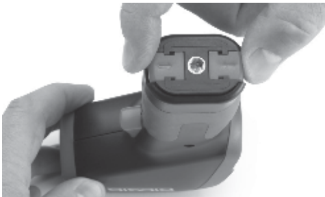
Figura 4 – Scoaterea compartimentului bateriei
