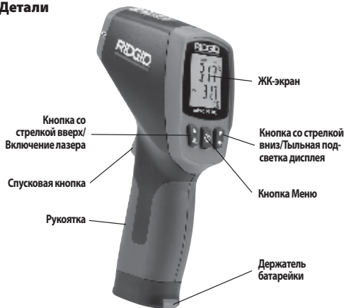
Рис. 2 – Детали прибора micro IR-100
