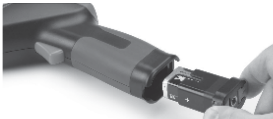
Slika 5 – Držač baterije i oznaka polariteta
