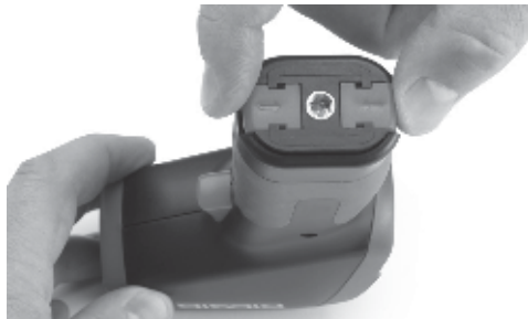
4. kép – Az elemtartó eltávolítása
